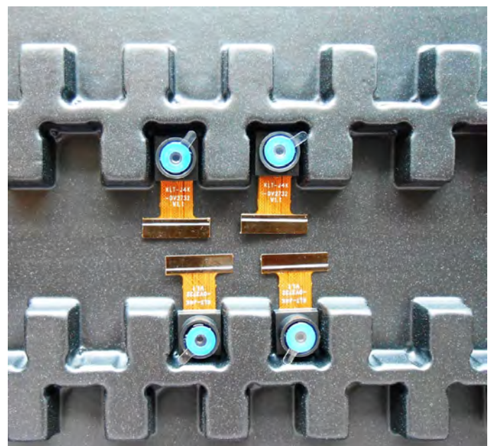
Legen Sie die Kameras auf das Tablett
